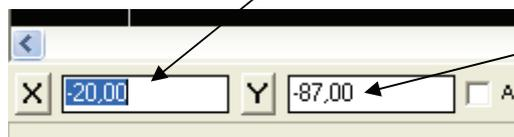
Para la línea vertical pulsamos (X 0) (Y 10) para dibujar la línea inclinada pulsamos (X -20) (Y -10). Y para terminar hacemos clic derecho
